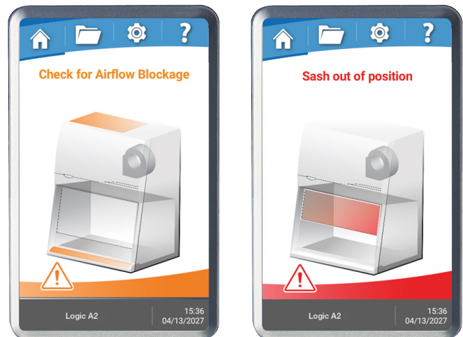
Sash Alarm display on Logic OS.
